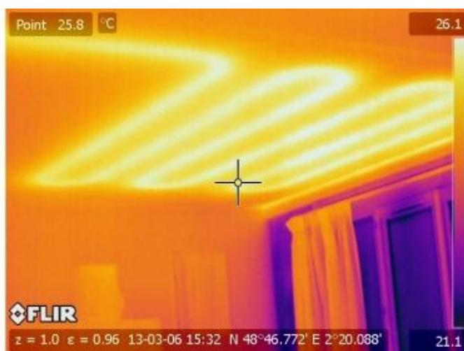
L'analyse montre en réalité une mauvaise répartition des canalisations dès la conception du bâtiment : certaines zones comportent des tuyaux espacés de 30 cm quand d'autres en sont exemptes. De plus, des canalisations longent les fenêtres, entraînant une déperdition thermique considérable. Les coûts de travaux étant prohibitifs, il ne sera guère possible de remédier à la gêne subie par les occupants.
